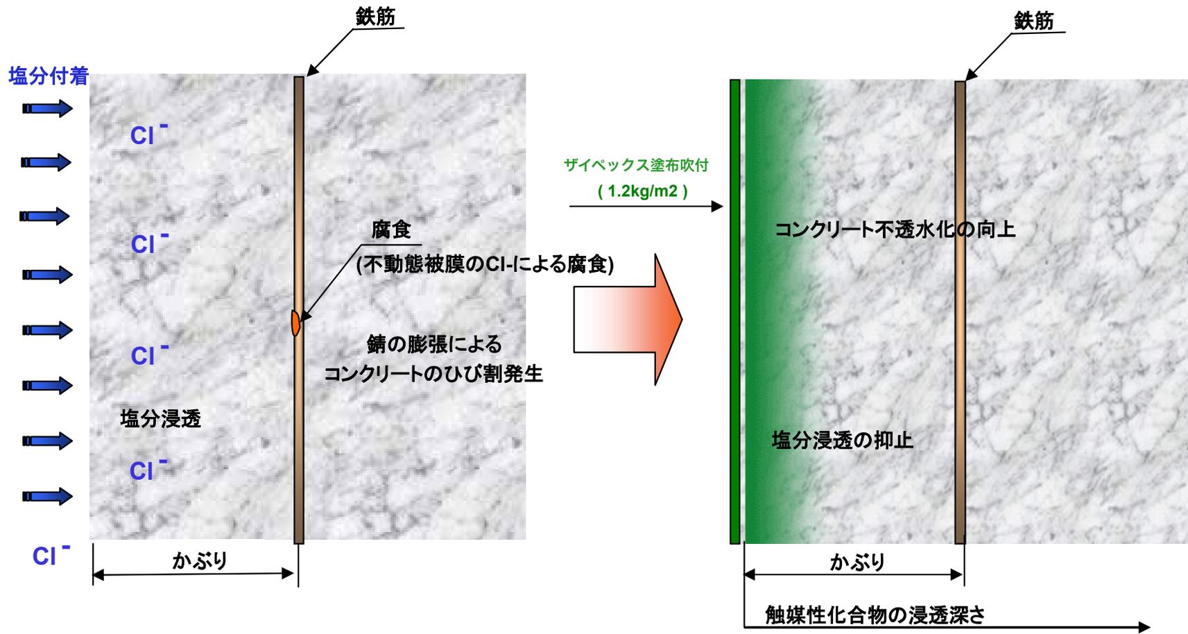
※ザイペックス処理されたコンクリートは、塩化物イオンの浸透抑止効果に優れています。
